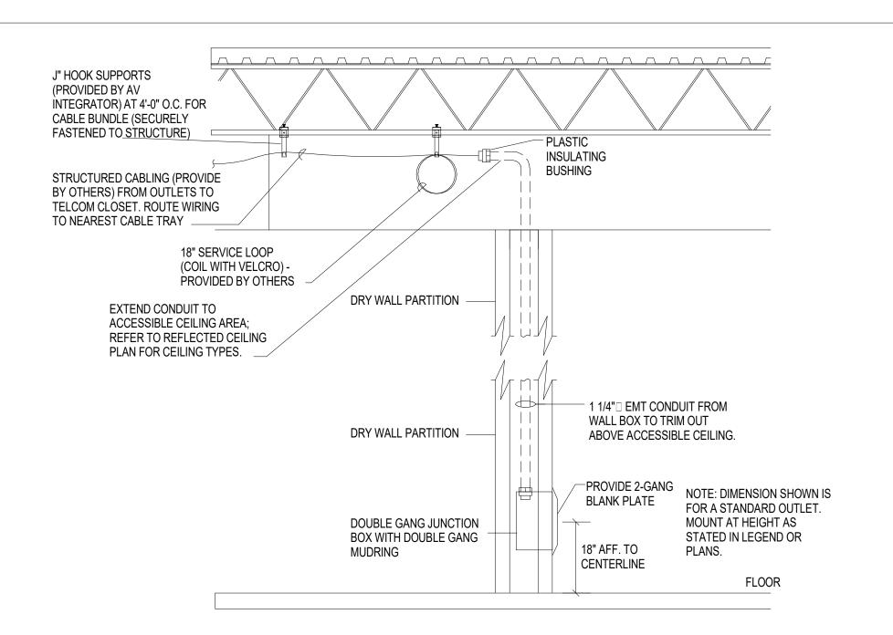
TYPICAL WALL-MOUNTED A/V OUTLET ROUGH-IN DETAIL
